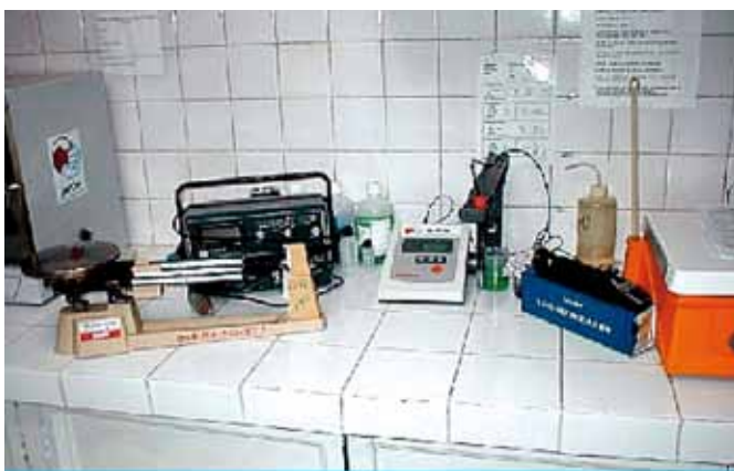
Figura 45b. Equipo básico de campo y de laboratorio con el que debe contar una granja camaronera. De izquierda a derecha se observa una balanza gramera, oxímetro (detrás), pH meter, salinómetro y agitador con plato caliente. Foto cortesía del Lic. M. De León.
