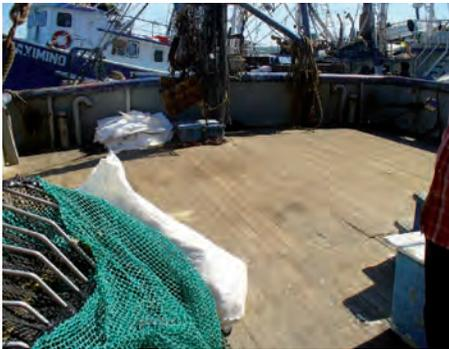
Figura 5. Las superficies de contacto (paredes, pisos, techos) deben ser de material no poroso y de fácil limpieza, por lo que la madera debe ser sustituida.
