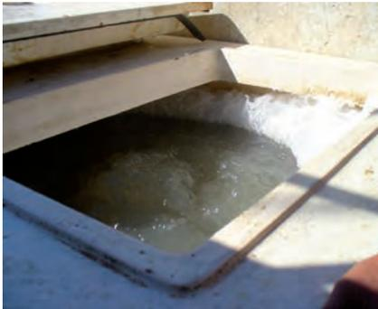
Figura 1. La temperatura de la salmuera, una vez introducida la carga debe ser menor a -18°C, para asegurar una rápida congelación del producto y para evitar el desarrollo microbiológico.
