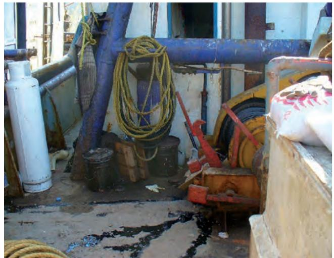
Figura 30. Debe evitarse que los cables representen un riesgo de contaminación con la grasa.
